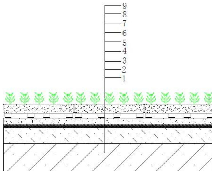
注：1-钢筋混凝土屋顶面板；2-（找坡）找平层；3-普通防水层；4-耐根穿刺防水层；5-聚乙烯膜或无纺布隔离层；6-20厚1:3水泥砂浆保护层；7-种植盆；8-40~150厚基质层；9-佛甲草、铺地锦竹等（苗圃预植）。
