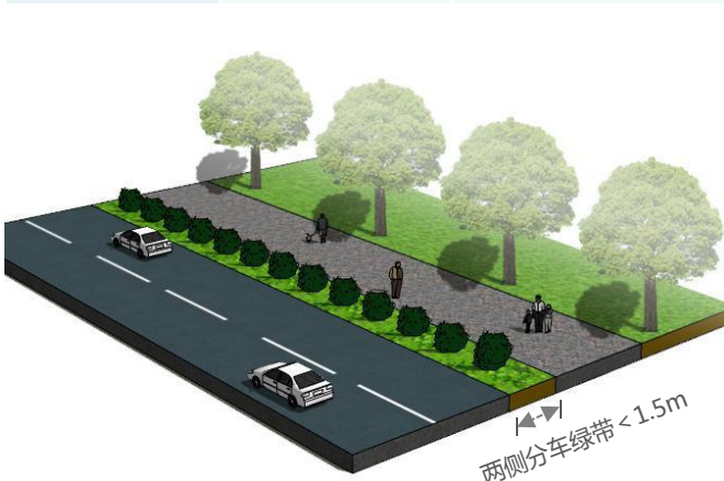
两侧分车带 < 1.5m绿化模式图
