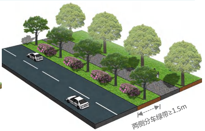
两侧分车带 ≥ 1.5m绿化模式图
